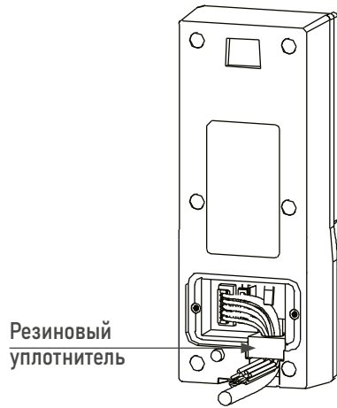
Рис. 5 Подключение и укладка коммутационных кабелей
