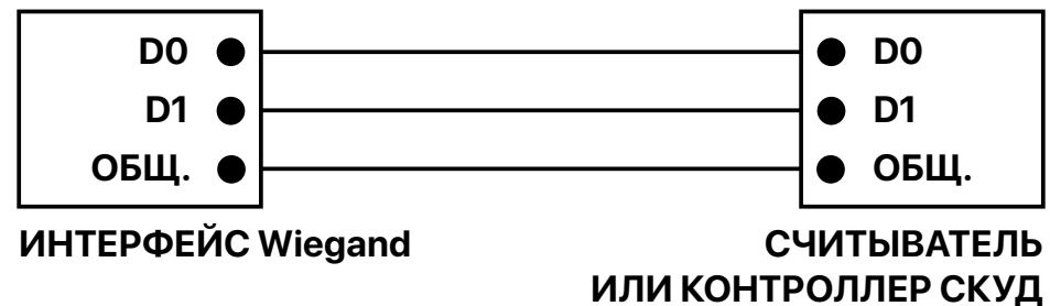
Рис. 11 Подключение RFID-считывателя или контроллера СКУД
