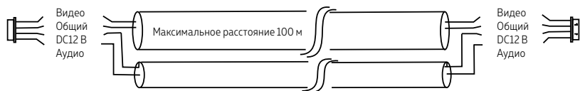
Рис. 8 Комбинированный видеокабель для подключения видеодомофона
