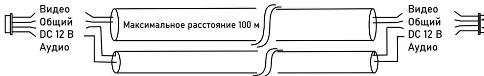
Рис. 9 Комбинированный видеокабель для подключения видеодомофона
