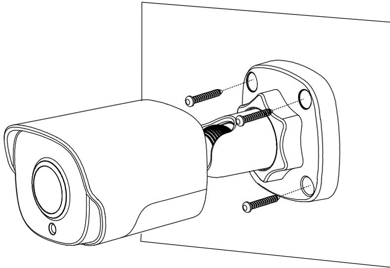
Рис. 9. Монтаж камеры
