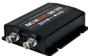
Позволяет увеличить расстояние передачи цифрового видео высокого разрешения на 130 м, используя только коаксиальный кабель. Исключительность устройства в том, что используя неограниченное число ретрансляторов, можно передавать цифровое видео на неограниченное расстояние. Поддерживается передача видео с разрешением 1920x1080 (60 к/с, 50 к/с).
